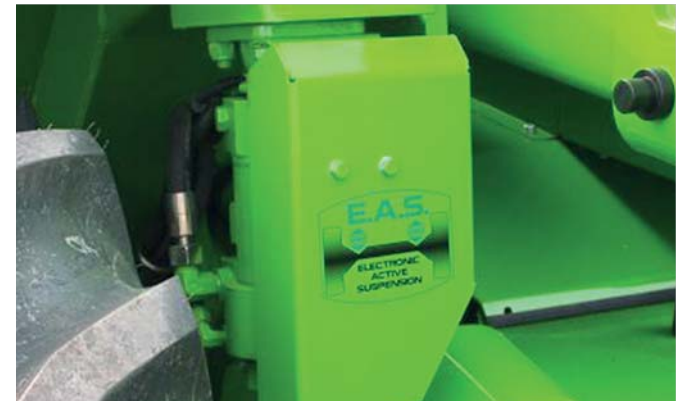
“EAS” Elektronisch veringsysteem, met vering vooraan (optioneel). Biedt zeer hoog rijcomfort en vergemakkelijkt werken op ruw terrein.
