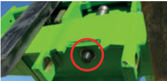
Tac-Lock : hydraulisch vergrendelingssysteem van de accessoire vanuit de cabine
