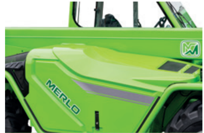
De nieuwe motorkap van de Panoramic met stabilisatoren, verlaagd voor betere zichtbaarheid opzij
