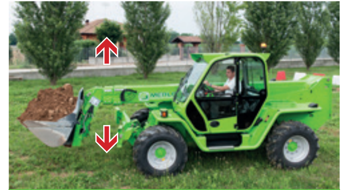
BSS hydropneumatische vering op de giek (optioneel op modellen 12/13 m). Activeerbaar door de bestuurder, versnelt verplaatsingen, beschermt de lading en verbetert productiviteit. Desactiveert onder 3 km/u.
