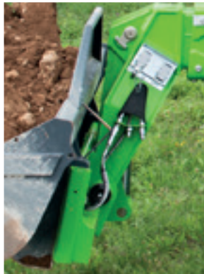
Leidingen, elektrische kabels en hydraulische hulplijnen liggen samen aan de binnenkant van de giek voor maximale bescherming
