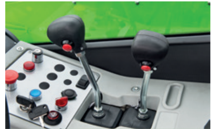
Versie 75 PK: hendels voor bediening van de giek, vorkenbord, accessoires en zijdelingse beweging giek
