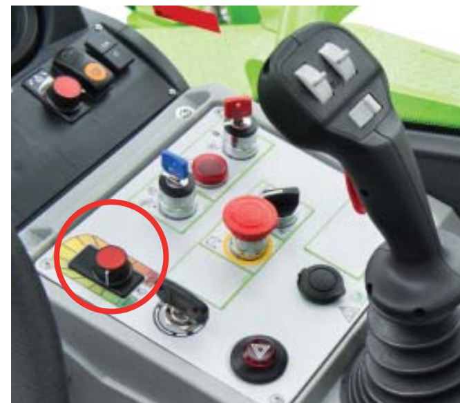
Potentiometer voor manueel instellen van het toerental van de dieselmotor
